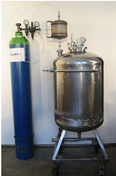
Abbildung 55: Inkubationsbehälter zur Bestimmung der Permeation von organischen Verbindungen durch Kunststoffflaschen
