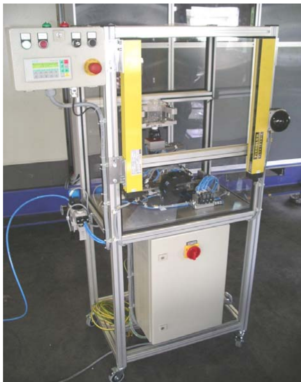
Abbildung 54: Versuchsaufbau zur Bestimmung der Permeation von Wasserstoff durch Kunststoffflaschen
