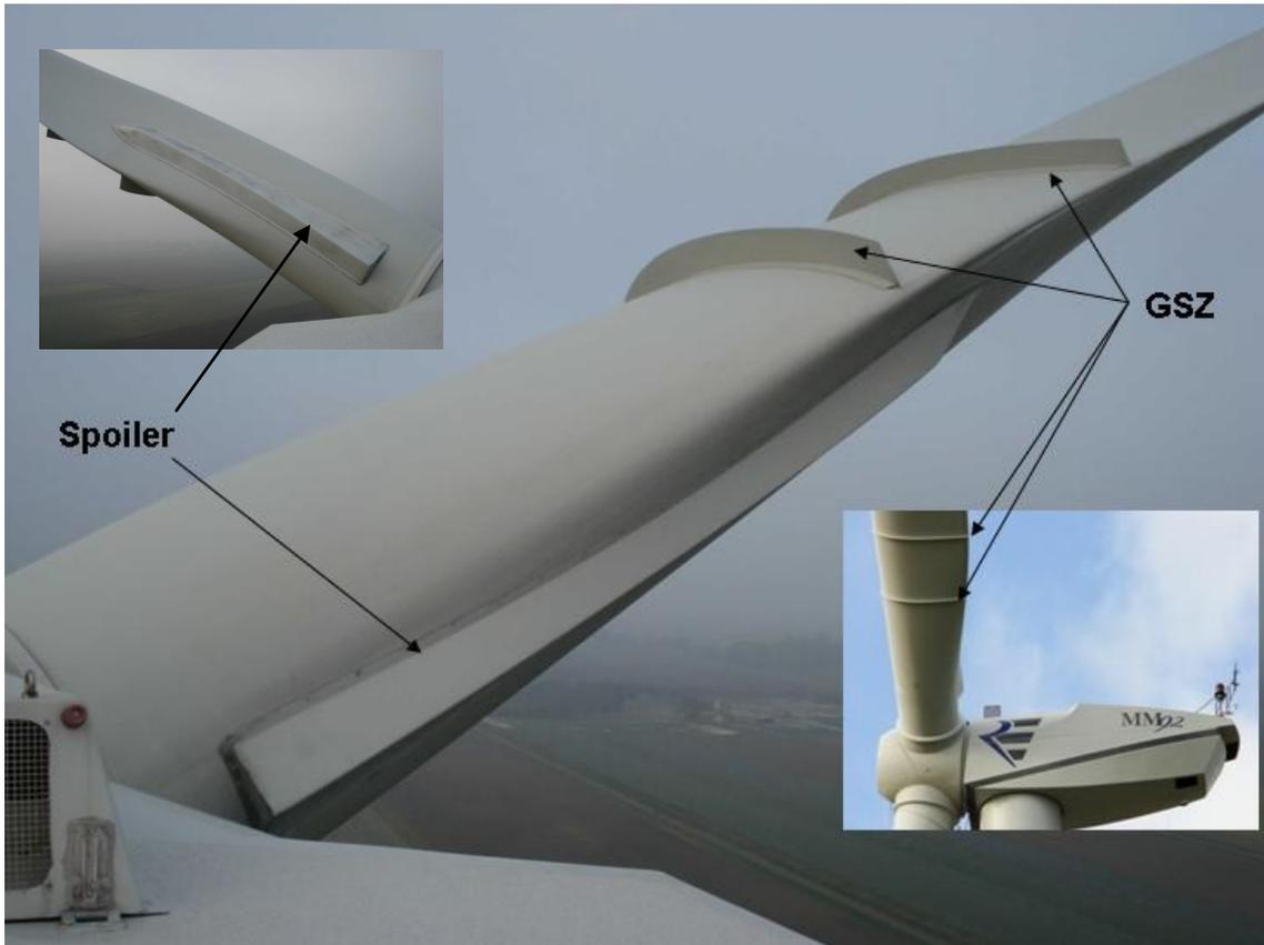
**Bild 5-8. Grenzschichtzäune auf der Saugseite und starrer Spoiler auf der Druckseite des Rotorblattes einer WEA der Multimegawattklasse [57,85]**
