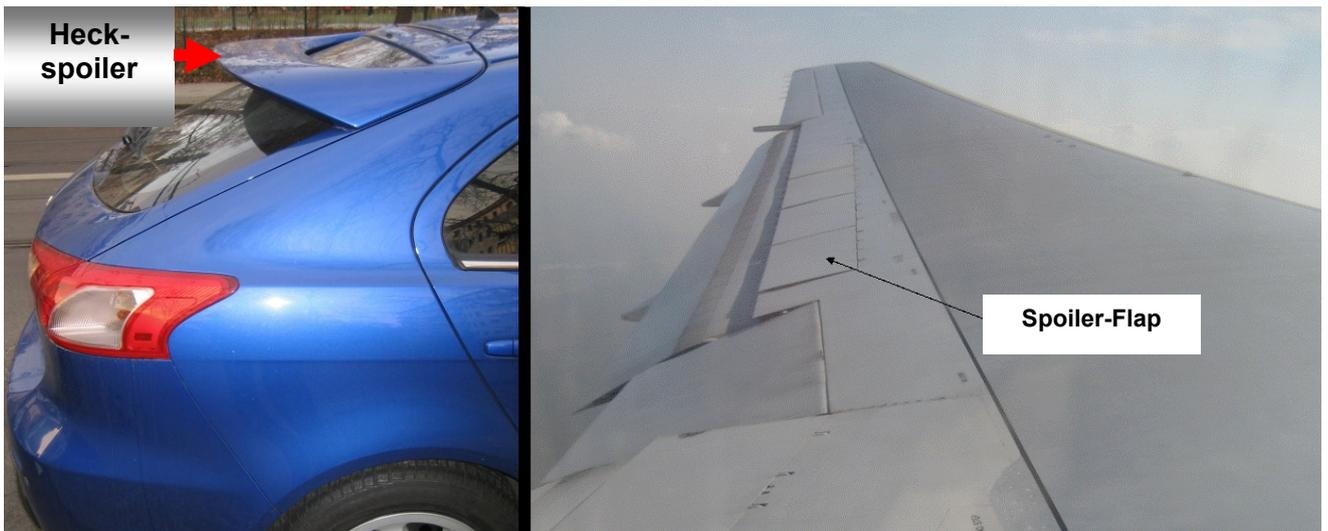
**Bild 5-11. Heckspoiler beim Personenfahrzeug (links) und Spoiler-Flap beim Flugzeug (rechts)**
