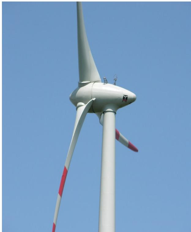
**Bild 4-6. WEA der Fa. Enercon mit umgestaltetem Nabenbereich**
