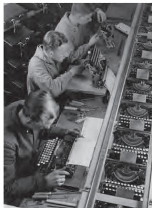
Ab 1924 wurden in deutschen Industriebetrieben Fließbänder eingesetzt. Dieses Bild zeigt die Produktion von Continental Schreibmaschinen um 1930.
